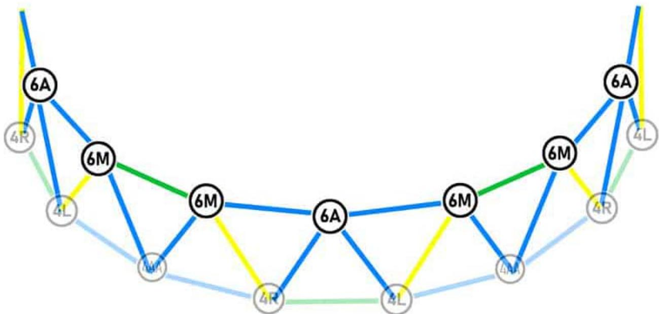
Um die Dreiecke so kurz wie möglich ohne Unterstützung zu lassen, bereiten wir den ersten Gürtel bereits auf dem Boden vor. Hierfür benötigen Sie
