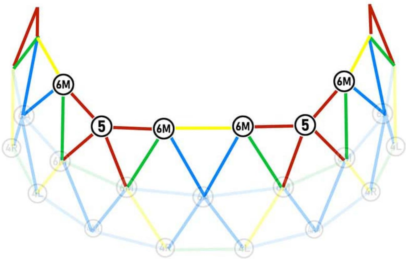
Wie bei der ersten Stufe werde ich den zweiten Gürtel bereits auf dem Boden vorbereiten, um die Dreiecke so kurz wie möglich ohne Unterstützung zu lassen.
