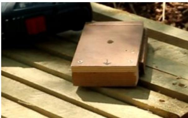
Stellen Sie nun die 2x25 Löcher in den Pfosten fertig, indem Sie Ihre Schablone verwenden und versuchen, so gerade wie möglich zu bohren. Wenn Sie eine Ständerbohrmaschine haben, ist jetzt der richtige Zeitpunkt, sie herauszuholen.
