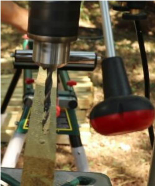
**Markieren Sie die Seite, auf der Sie den Bohrer eingeführt haben:** Diese Seite wird an die Steckverbinder angelegt, da sie am genauesten ist.
