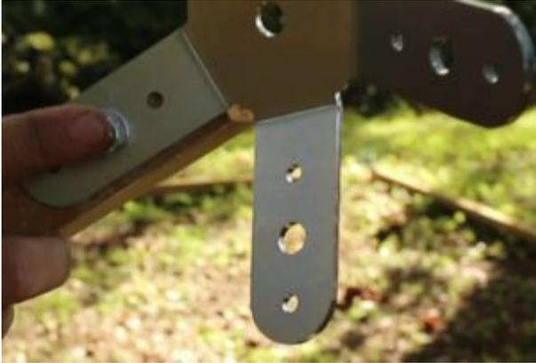
Nehmen Sie die letzten 6 fünfarmigen DOMESTAR-Verbinder und schrauben / bolzen Sie je 1 Verbinder an 6 neue Pfosten.
