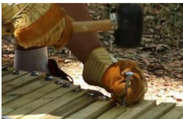
**Tipp:** Wenn der Hammer nicht ausreicht, können Sie auch eine Schraube und eine Unterlegscheibe verwenden und die Schraube anziehen, damit sie gut in das Holz eingreift.
