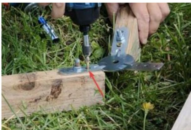
Aquí están los conjuntos de 3 montantes listos para ser colocados (a diferencia de esta imagen, recuerde utilizar 2 tornillos para madera por rama):
